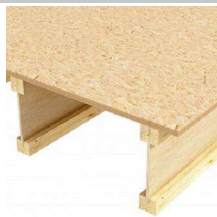
Assemblage de panneaux de plancher sur solives
